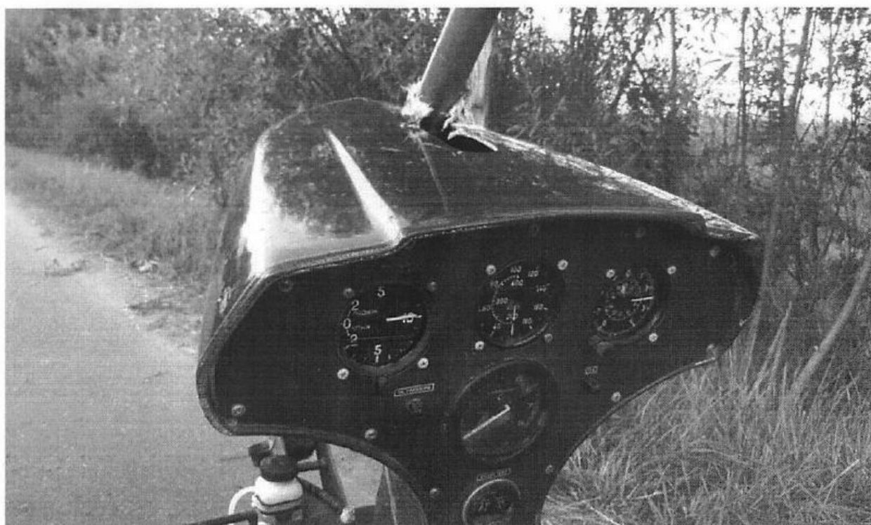
Фото 2. Повреждение обшивки обтекателя приборов
